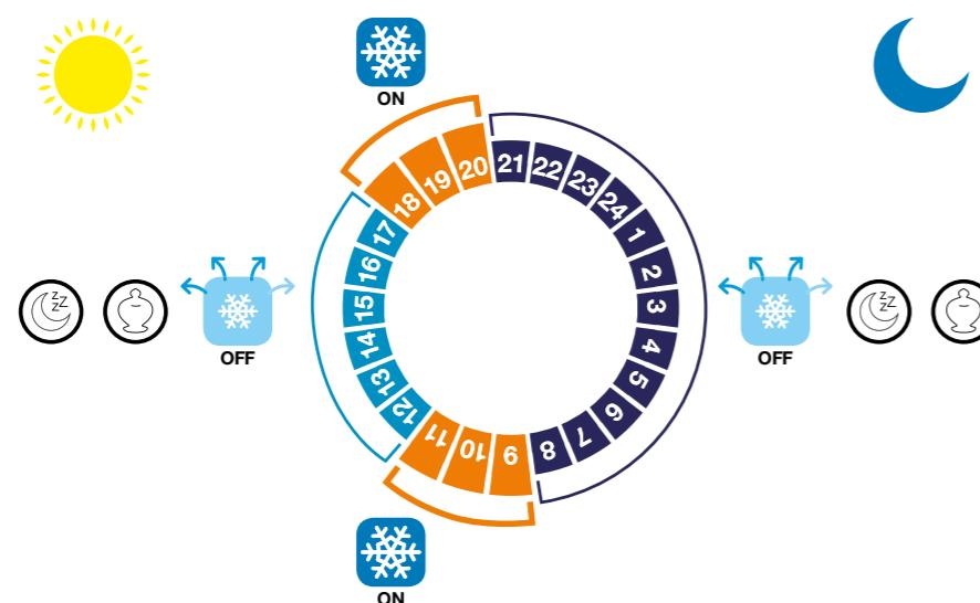
Il **timer elettronico** programma i tempi di funzionamento del compressore per un minimo di 6 ore nell'arco delle 24 ore (i consumi energetici sono estremamente contenuti).
